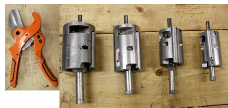
Exempel på verktyg som kan ingå i verktygssatsen; slangkap, och slangsvavar
