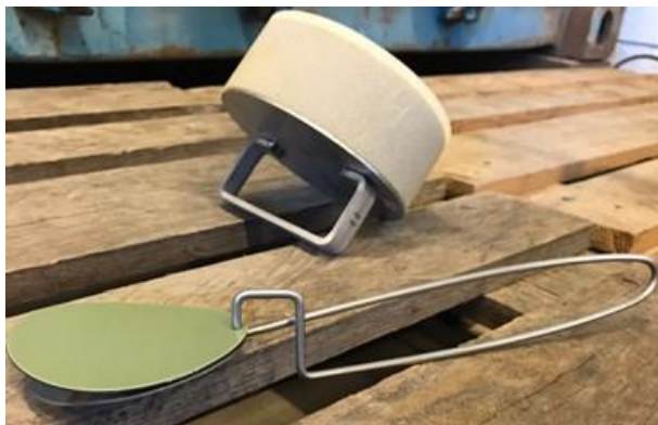
Exempel på verktyg vid förvärmning av fops samt applicering av fops.
